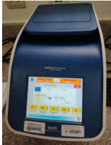
El termociclador que se utilizó en este estudio de marca Applied Biosystems, un producto de Thermo Fisher Scientific. Específicamente, se trata del modelo Veriti 96-Well Thermal Cycler, un termociclador utilizado para la reacción en cadena de la polimerasa (PCR).
