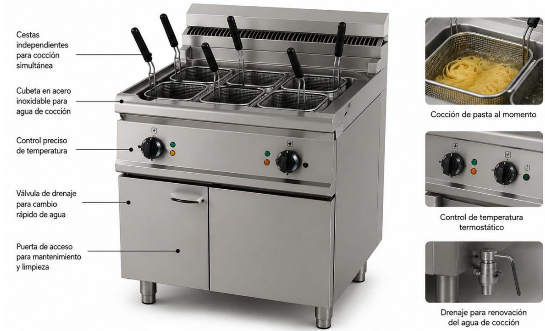
Figura 8. Cocedero de pasta profesional de acero inoxidable equipado con cubeta de agua caliente, cestas independientes, control termostático y sistema de drenaje para renovación del agua de cocción. Fuente: The Culinary Institute of America [34].
