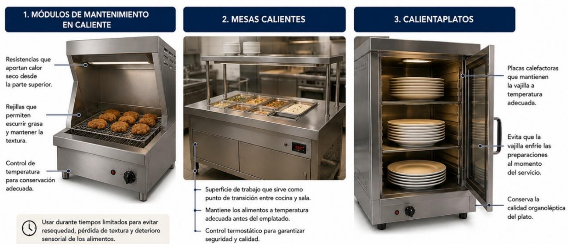
Figura 11. Equipos de mantenimiento térmico utilizados en cocinas profesionales para conservar alimentos y vajilla en condiciones adecuadas antes del servicio. (1) Módulo de mantenimiento en caliente con resistencias superiores y rejillas de escurrido; (2) Mesa caliente o mesa de mantenimiento térmico; (3) Calientaplatos profesional. Fuente: The Culinary Institute of America [34].
